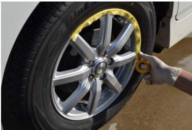
③養生 ホイールの際をマスキングテープで 養生。 ※付着した場合はすぐに拭き上げる。
