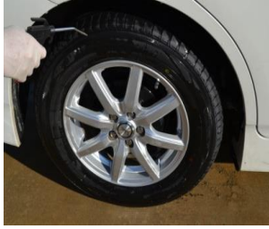
②乾燥 ブロアーなどで水気を完全に除去し乾燥させる。 水洗い後は乾き色になるまで乾燥させる。
