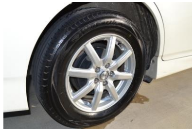
⑥塗布完了 塗りムラ、塗り忘れ、異物の付着などが無いかよく確認し、作業完了。 ⑦塗布後は約10分以上乾燥させ施工面を触らないようにする。
