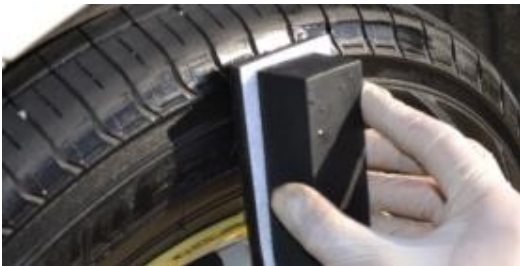
⑤整え作業 追いかけ作業で今度は薄塗せず 全体を整えるように仕上げる。
