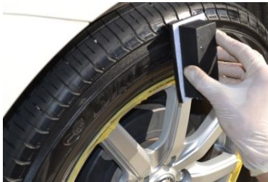
④コーティング塗布 コート剤使用前には容器をよく振ります。 スポンジにコート剤を適量付け、まずは薄く全体にすり込むように塗り込みます。 ※すぐに容器のキャップを閉め、水気、空気との接触を避ける。
